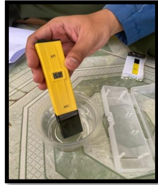
Pengukuran pH Air Sumur
