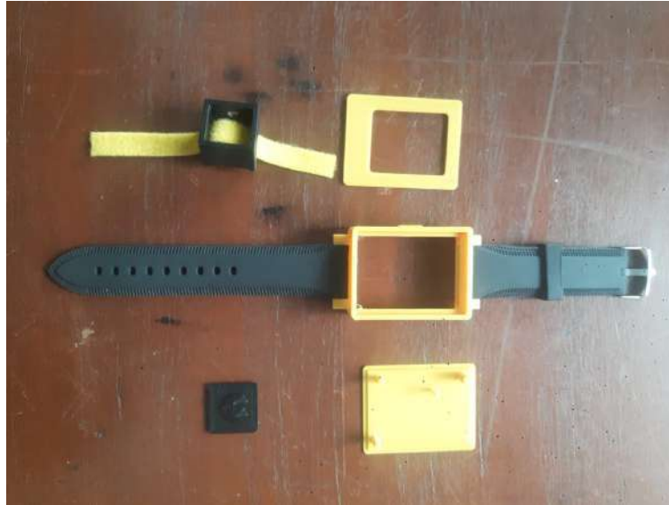
Gambar 28. Case Jam Tangan dan Cincin Setelah Finishing
