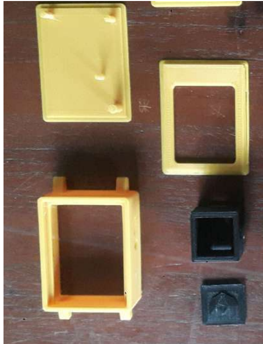
Gambar 27. Hasil Cetak Print 3D Case Jam Tangan dan Cincin
